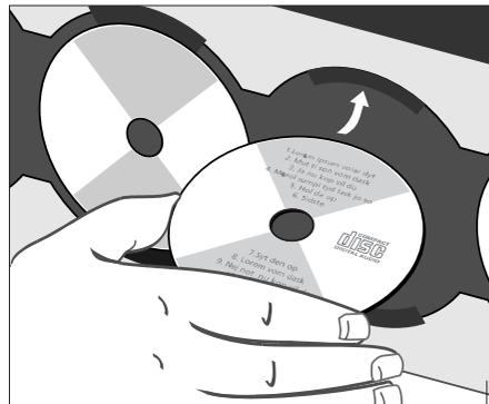
*Il CD deve essere caricato con il lato stampato rivolto verso l'esterno. Afferrare il CD per il bordo e inserirlo nel vano (parte superiore). Per rimuovere il CD, afferrarlo per il bordo e tirare leggermente in avanti per liberarlo.*
